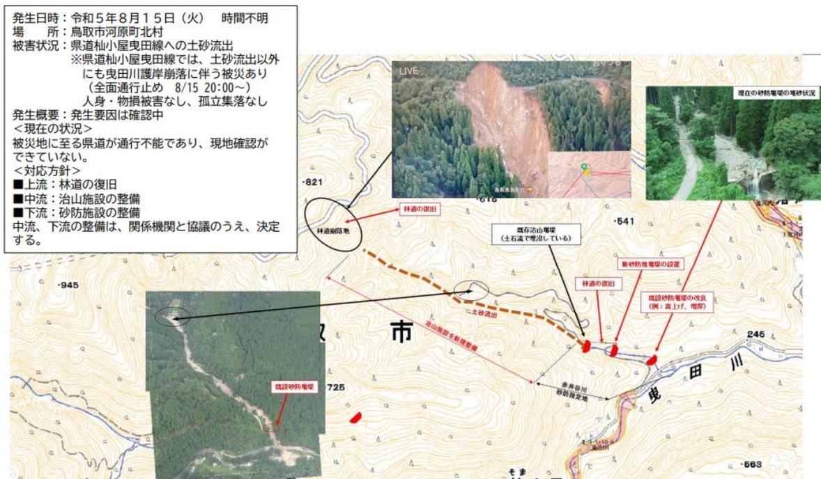
図-2 赤井谷川 (鳥取市河原町北村) の土砂流出
