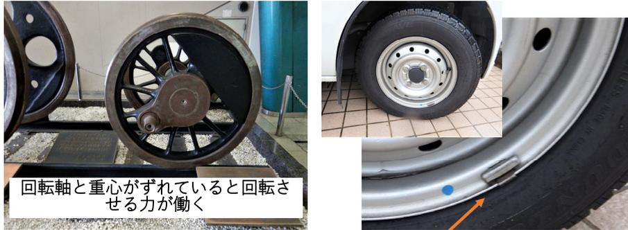
回転軸と重心がずれていると回転させる力が働く
