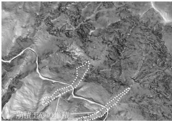
図8 落石の多い急崖斜面地形
