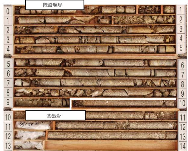
写真-5 C砂防堰堤ボーリングコア（堰堤水通し部）
