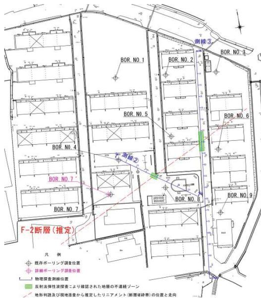
図-8 反射法弾性波探査位置
