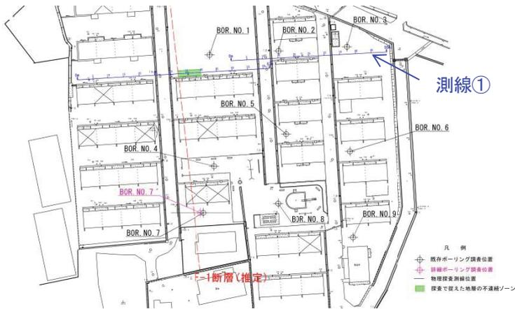
図-6 F-1 断層に対する反射法地震探査位置
